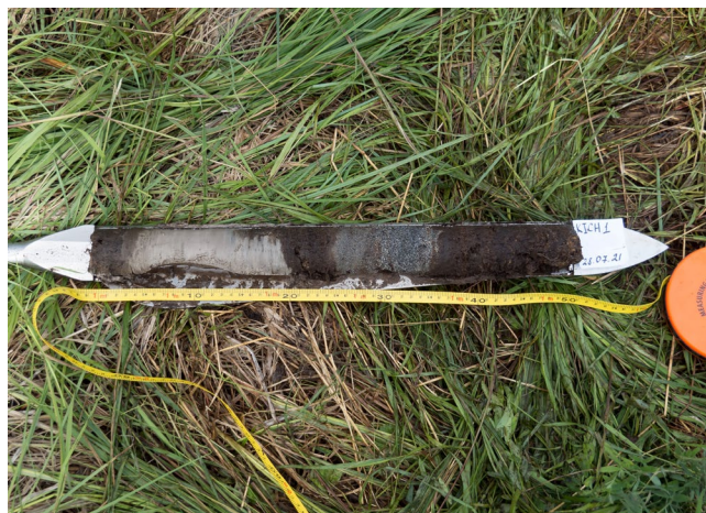
Рис. 3. Керн скв. Кич с глубин 1–1.5 м. Переслаивание торфа и пепла различного состава.
