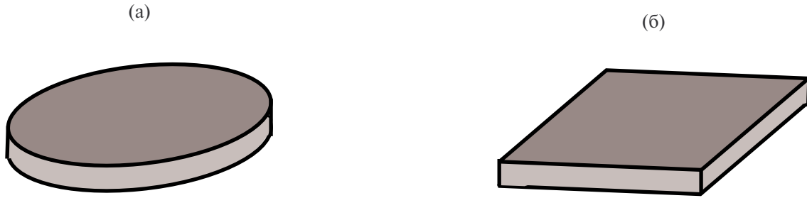
Рис. 1. Круглая (а) и прямоугольная (б) прокладки. Жестко защемленные основания глубоко тонированы.
