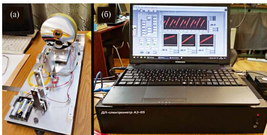
Рис. 3. а) Общий вид приемно-передающего блока лидара дифференциального поглощения, б) электронный блок управления лидара с компьютером наверху, на мониторе которого показаны примеры перестройки частоты лазеров путем изменения тока накачки.
