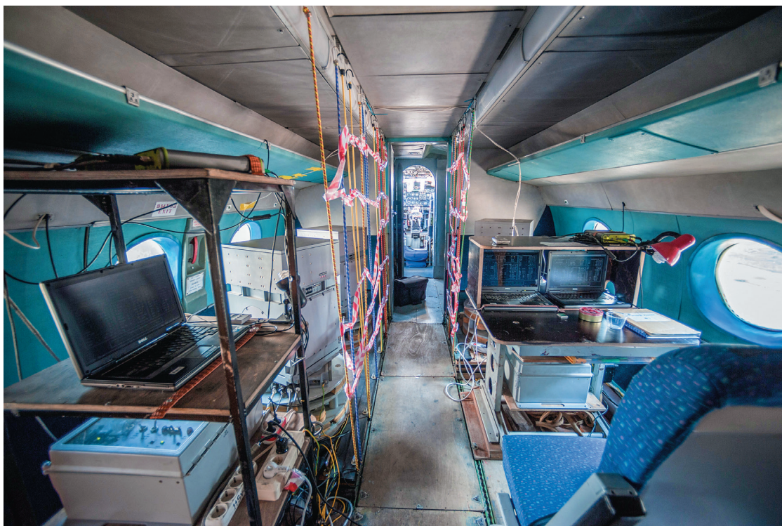
Рис. 1. Аэрогравиметрическая лаборатория на борту АН-26БРЛ.
