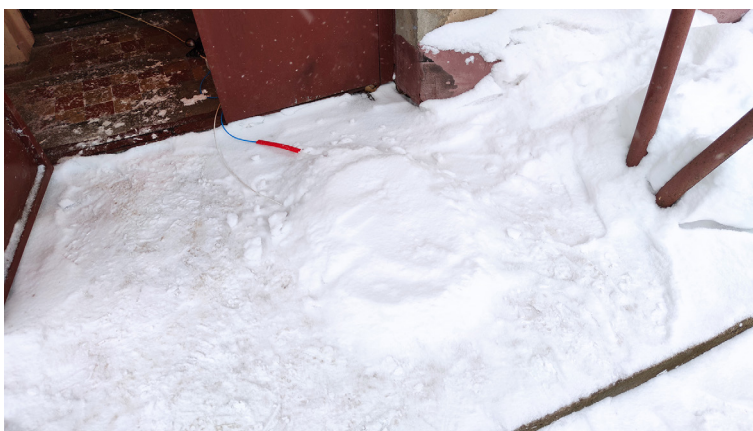
Р и с. 6. Выдерживание изделия под снегом на морозе в течение 4 часов
