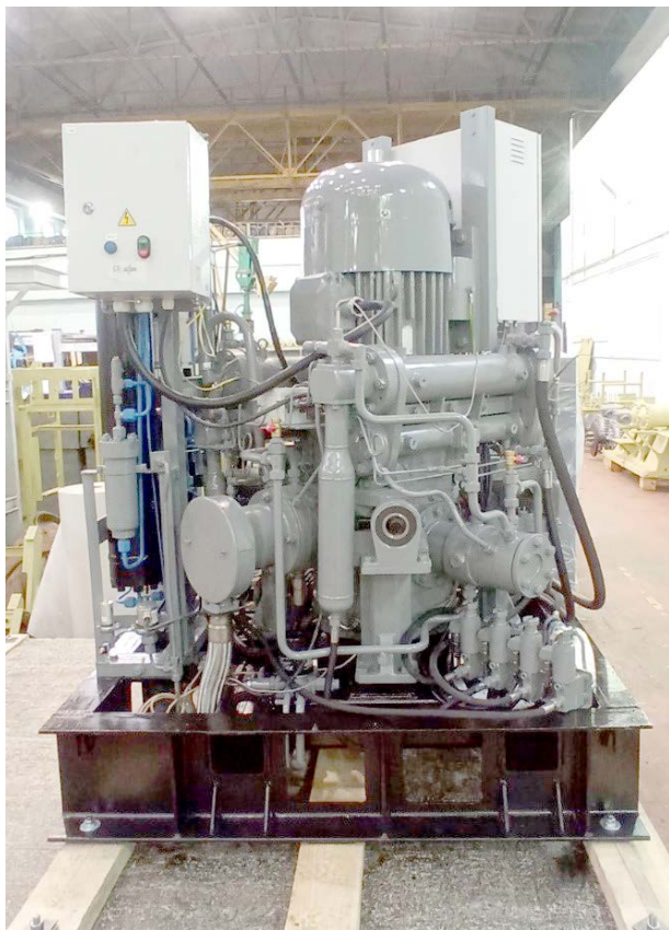
Рис. 1. Станция компрессорная автоматизированная СКА 60/200
