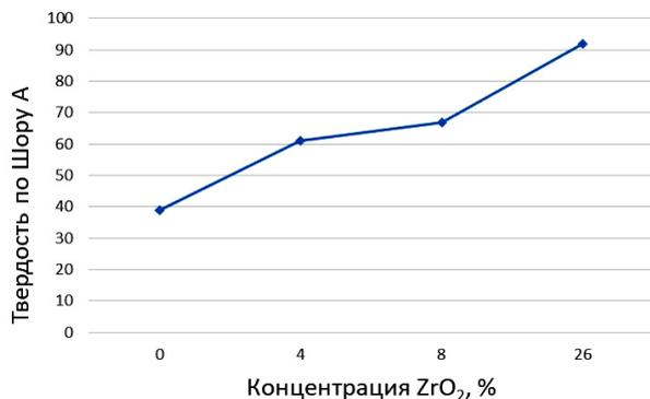
Рис. 5. Зависимость твердости ПКМ по Шору А от концентрации диоксида циркония  $ZrO_2$
