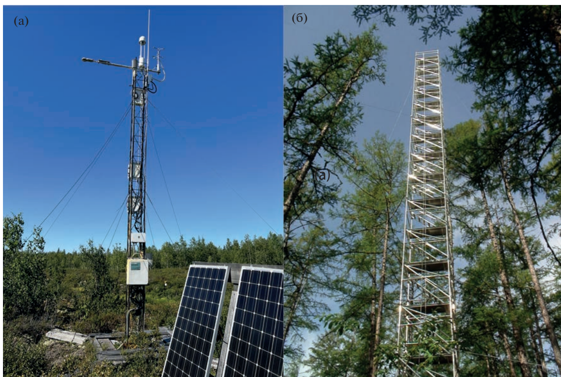
Рис. 3. Типичные измерительные комплексы RuFlux: (a) на плоскобугристом болоте (высота вышки 6 м, станция KR-Iga) и (б) в лесу (высота вышки 34 м, станция YA-Elg).
