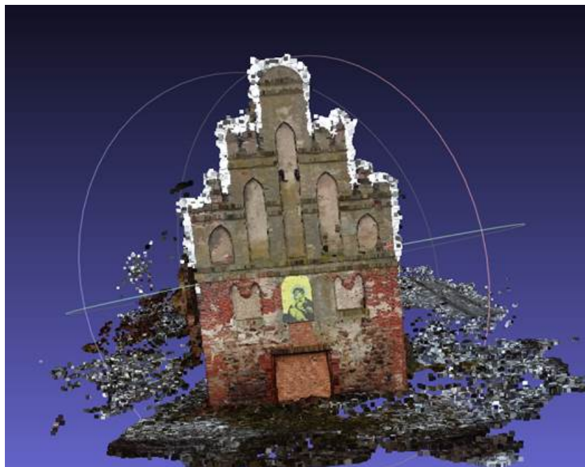
Рис. 10. Плотное облако точек кирпичи Побетен в программе-вьюере для проверки и последующего редактирования.
