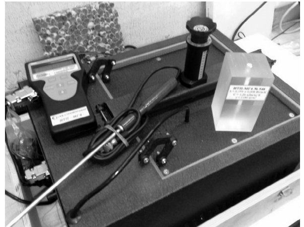
Рис. 2. Измеритель теплопроводности ИТП-МГ 4 «250» Fig. 2. Thermal conductivity meter ИТП-МГ 4 “250”
