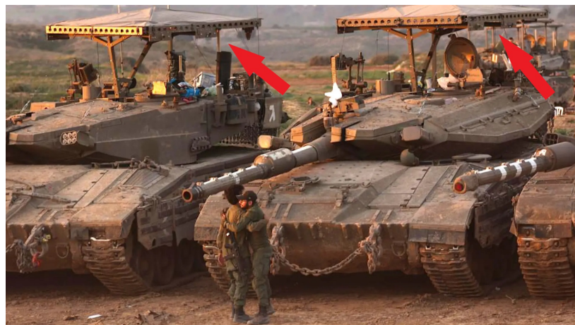
Рисунок 7. Израильский танк «Merkava» с улучшенным антидроновым козырьком, 21 января 2024 года.
