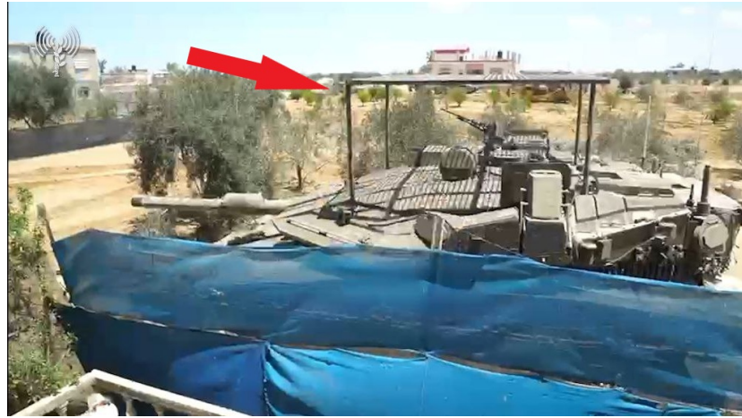
Рисунок 6. Израильский танк «Merkava» с первоначальным вариантом антидроновой козырька, начало операции в Рафахе.
