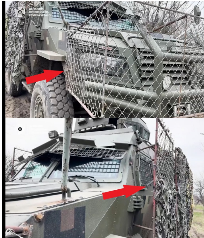
Рисунок 5. Канадский бронеавтомобиль «Roshel» ГПСУ с кустарной антидроновой защитой из сетки рабицы.
