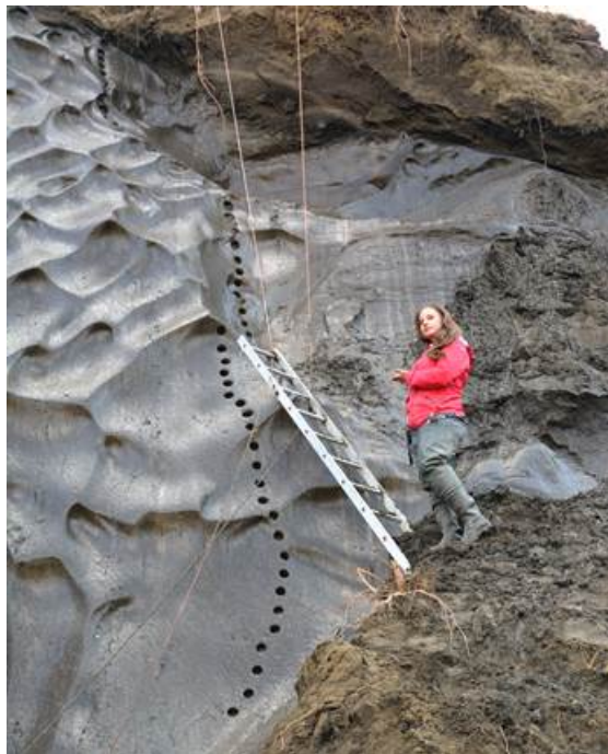
Рис. 6. Трасса отбора образцов с помощью электродрели (круглые лунки) из обнажения повторно-жильных льдов ПЖЛ-7
