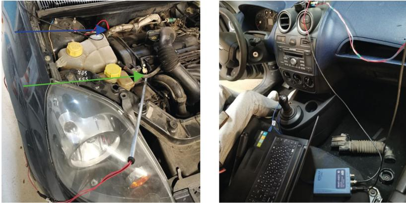
Рис. 2. Подключение измерительного оборудования
