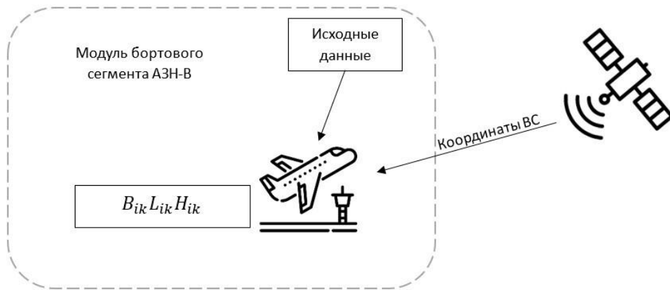
Рисунок 2 – Определение координат ВС при помощи ГНСС
