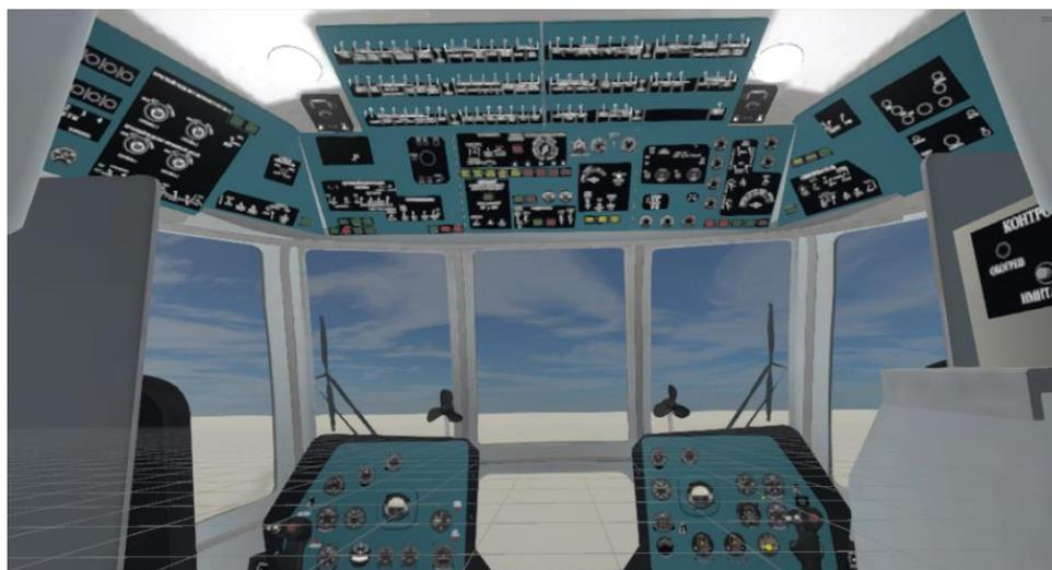
Рисунок 5 – 3D модели панелей и пультов управления
