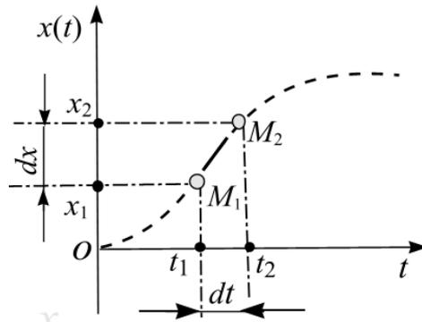
Рисунок 4 – График неравномерного прямолинейного движения точки
