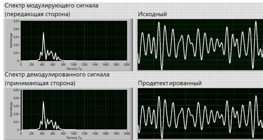
Рисунок 1 – Глубина модуляции 1, искажений нет
