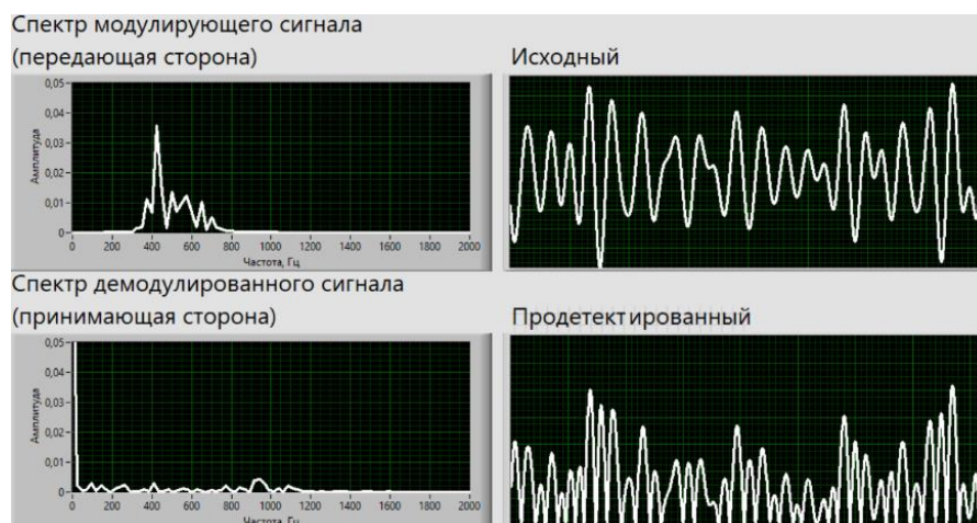
Рисунок 5 – Глубина модуляции 5, сигнал близок к балансному, энергетика перераспределилась в область более высоких частот, восприятие речи невозможно
