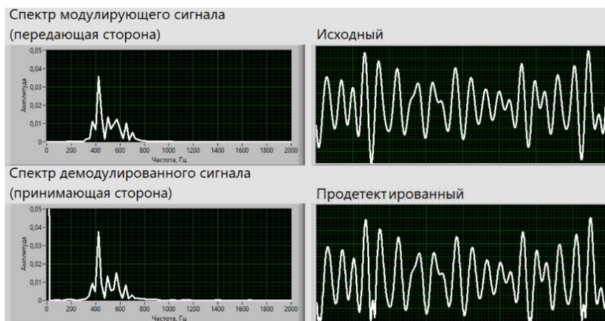
Рисунок 2 – Глубина модуляции 1.4, искажения незначительны, восприятие речи возможно
