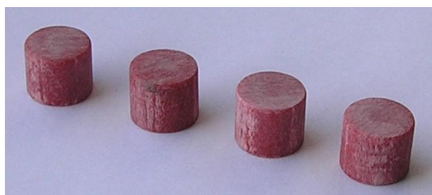
Рис. 5. Внешний вид образцов ВПКМ перед испытаниями на сжатие.
