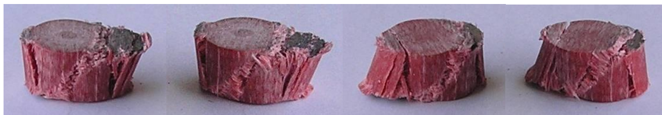
Рис. 6. Внешний вид образцов ВПКМ после испытаний на сжатие при температурах: а – 20 °С, б – 100 °С, в – 130 °С, г – 160 °С.
