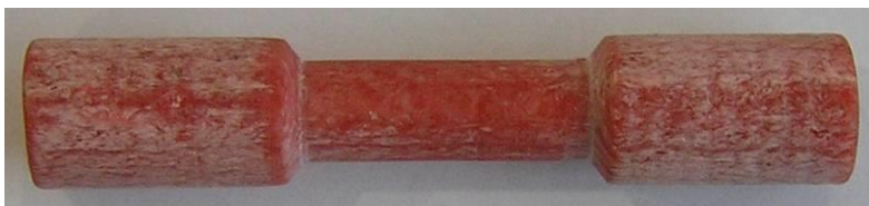
Рис. 1. Внешний вид образцов ВПКМ перед испытаниями на разрыв.
