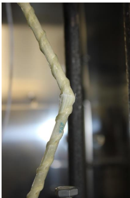
Рис. 2. Характер разрушения арматуры.
