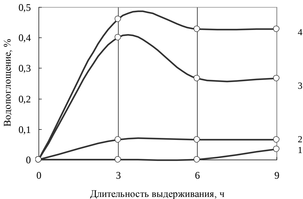
Рис. 3. Зависимость изменения водопоглощения наполненных эпоксидных композитов после выдерживания образцов в воде при t=80\text{ }^{\circ}\text{C} от содержания биоцидной добавки «Тефлекс» (обозначения те же, что и на рис. 1)
