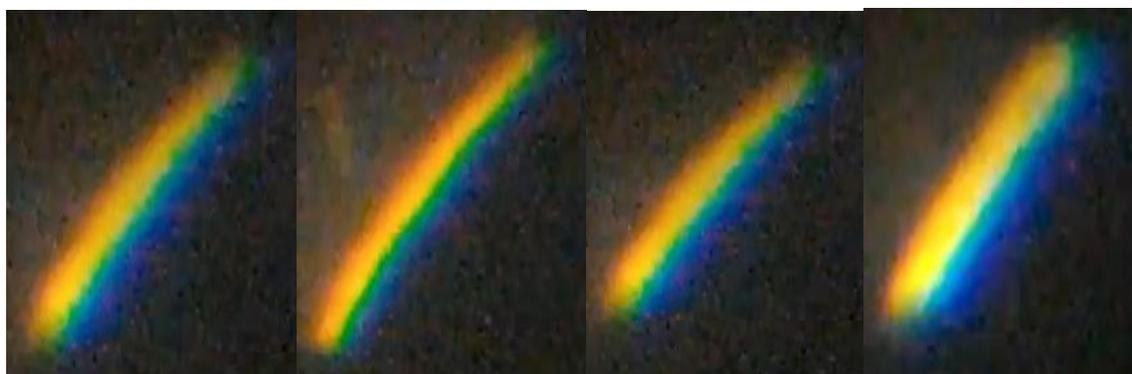
Рис. 7. Фото фиксация спектров вспышки плазмы
