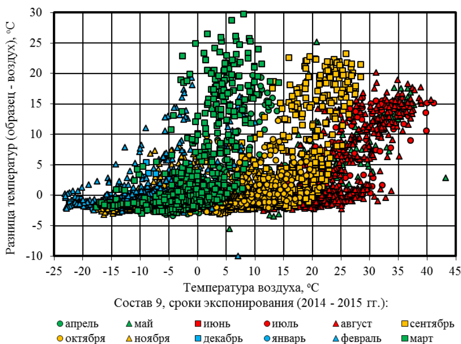
Рис. 1. Изменение прироста температур поверхности образца в зависимости от температуры окружающего воздуха.
