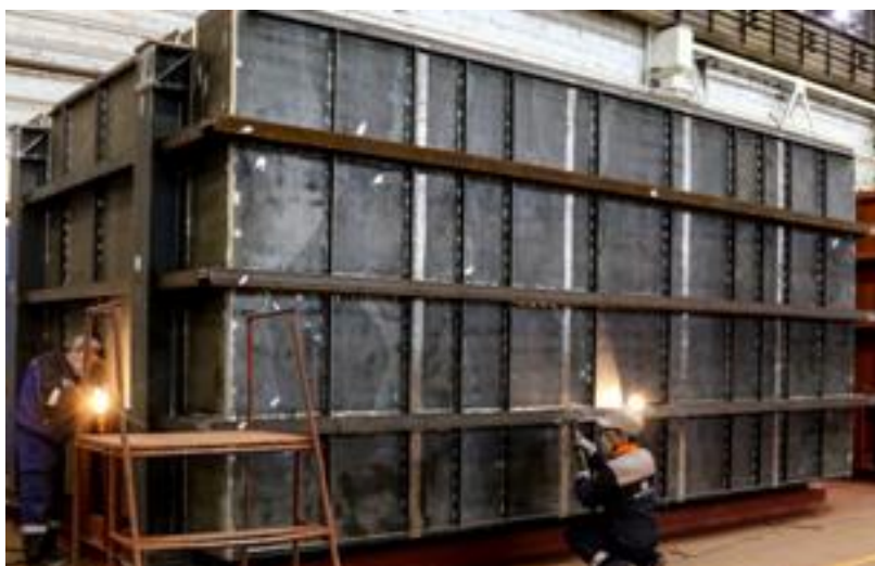
Рис. 4. Изготовление энергетической котельной установки [8]
