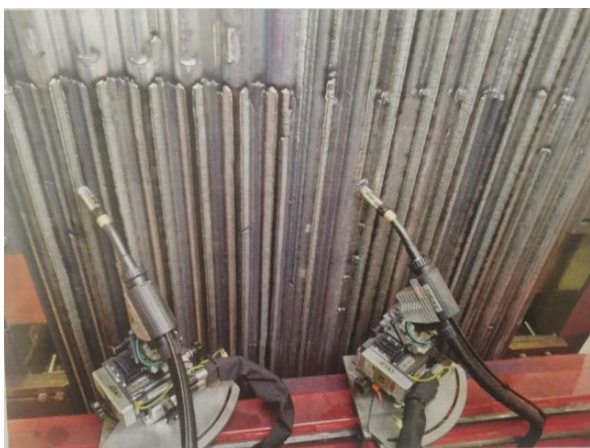
Рис. 6. Наплавка газоплотных панелей с СМТ-переносом.
