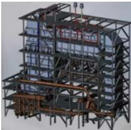
Рис. 3. Металлический каркас мусоросжигательного комплекса [2].
