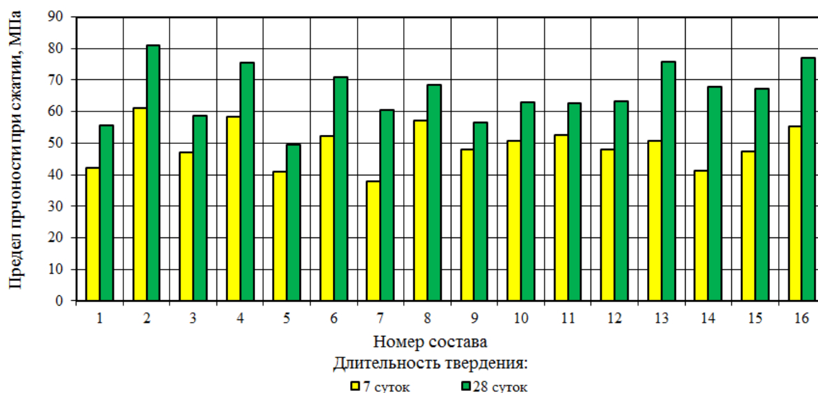
Рис. 1. Предел прочности при сжатии модифицированных цементных композитов в возрасте 7 и 28 суток.
