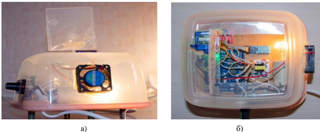
Рис. 2. Внешний вид макета САУ температурой: а) вид спереди; б) вид сверху.
