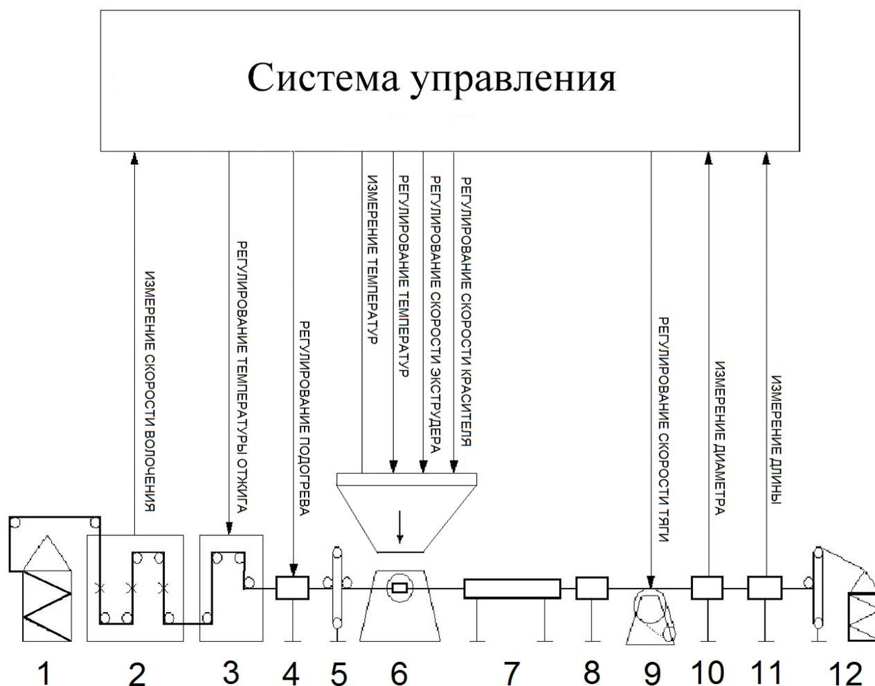
*1 – отдающее устройство; 2 – волочильная машина; 3 – отжиг жилы; 4 – подогрев жилы; 5 – компенсатор; 6 – экструдер; 7 – охлаждающая ванна; 8 – сушильное устройство; 9 – тяговое устройство; 10 – датчик диаметра; 11 – счетчик длины; 12 – приемник*
