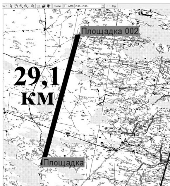
Рис. 3. Моделируемый в ONEPLAN RPLS-DB Link радиорелейный интервал.
