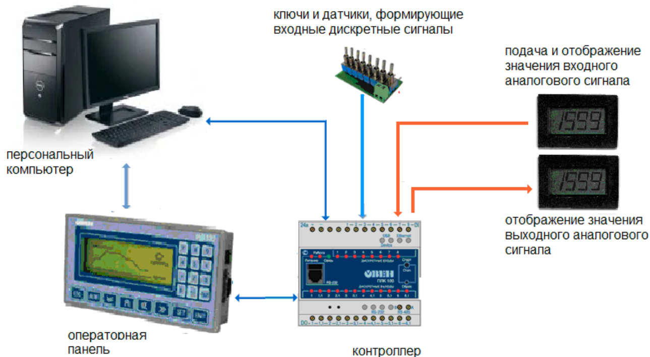
Рис. 1. Структура учебного стенда, включающая ПЛК и компоненты, формирующие и отображающие дискретные и аналоговые входные/выходные сигналы.
