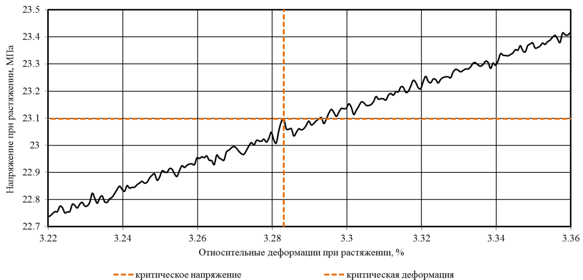
Рис. 1. Общий вид (а) и фрагмент (б) кривой деформирования образцов эпоксидных полимеров при растяжении (сплошной линией красного цвета на рисунке «а» обозначен уровень максимальных напряжений и соответствующих им деформаций).
