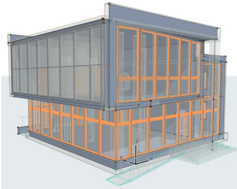
Рис. 17. Аналитическая Модель торгового центра, выполненная в ArchiCAD, с наложением прозрачной Физической Модели.
