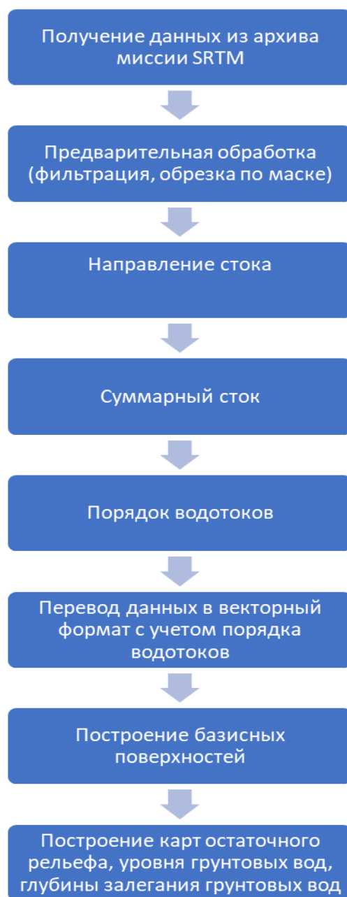
Рис. 1. Схема обработки данных в ГИС ArcGIS.
