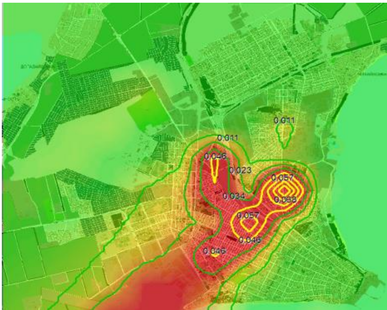
Рис. 3. Прогностическая модель распределения загрязнителей в атмосферном воздухе [4].
