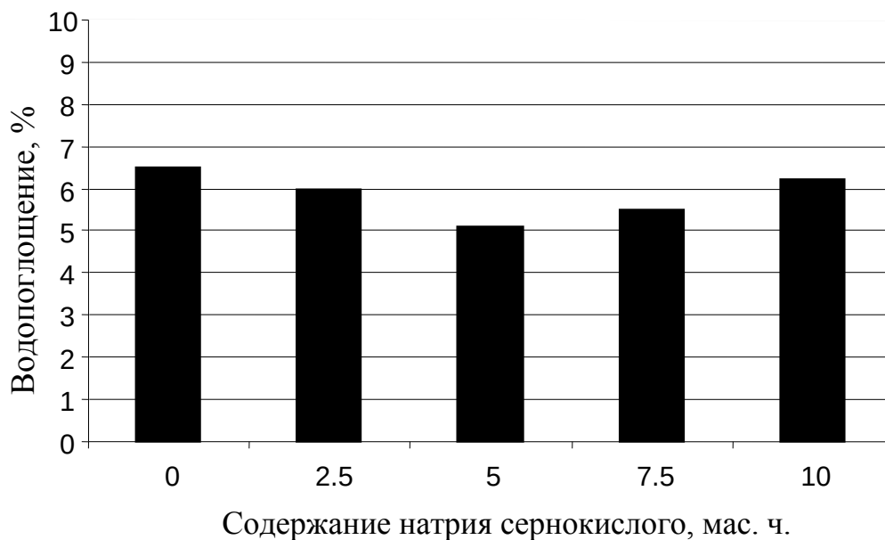
Рис. 4. Зависимость изменения водопоглощения композитов на основе цемента М500 Д0 от количественного содержания натрия сернокислого
