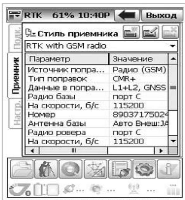
Рис. 2. Настройка контроллера JAVAD Victor на RTK-режим.
