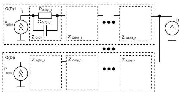
Рис. 1. Линейная электротепловая модель силового модуля.
