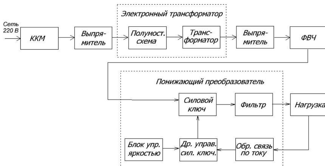
Рис. 2. Функциональная схема источника питания.
