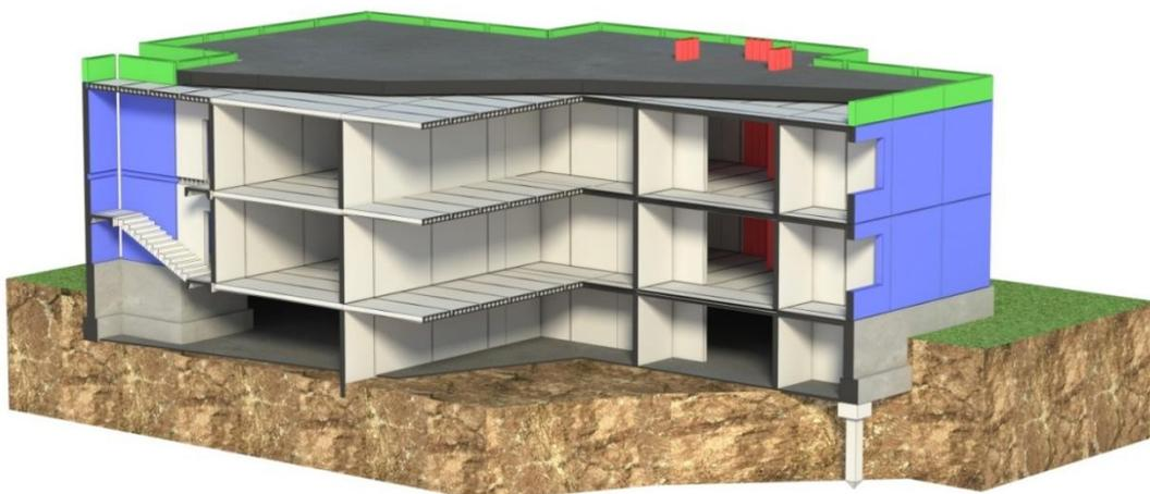
Рис. 2. 3D разрез общественного здания, представляющий основные конструктивные элементы.
