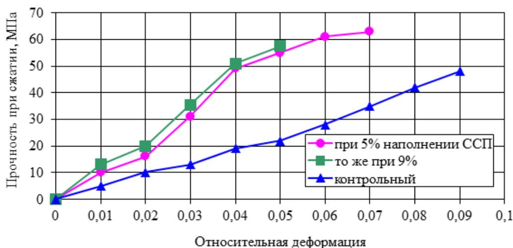
Рис. 1. Зависимость относительных деформаций цементных композитов от напряжений сжатия.
