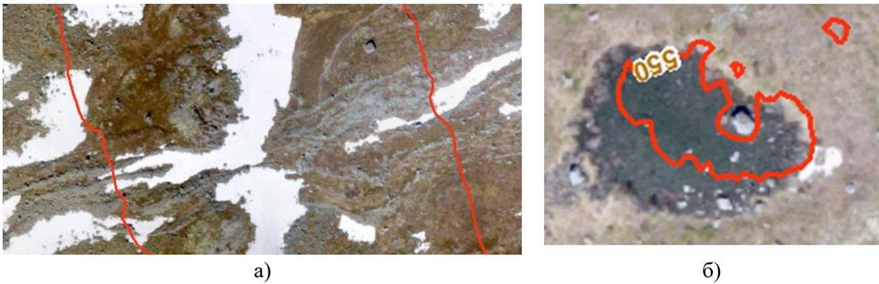
Рис. 3. Ошибки автоматизированной прорисовки горизонталей.
