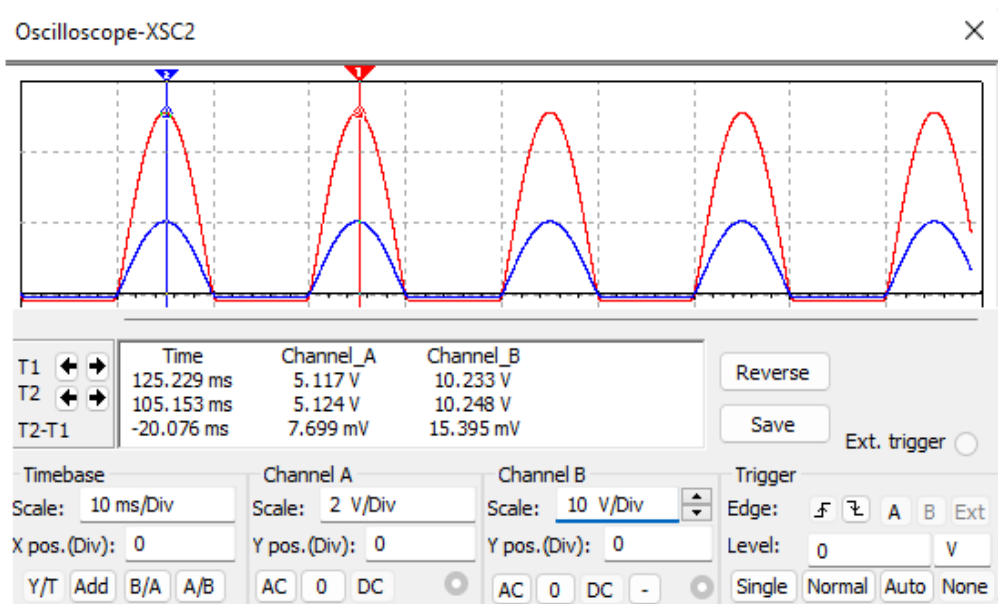
Рис. 5. Осциллограммы управляющих импульсов напряжения на входе МУ (линии красного цвета) и выходе МУ (линии синего цвета).
