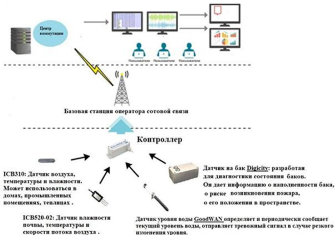
Рис. 2. Система контроля и управления обслуживанием сельскохозяйственных территорий.
