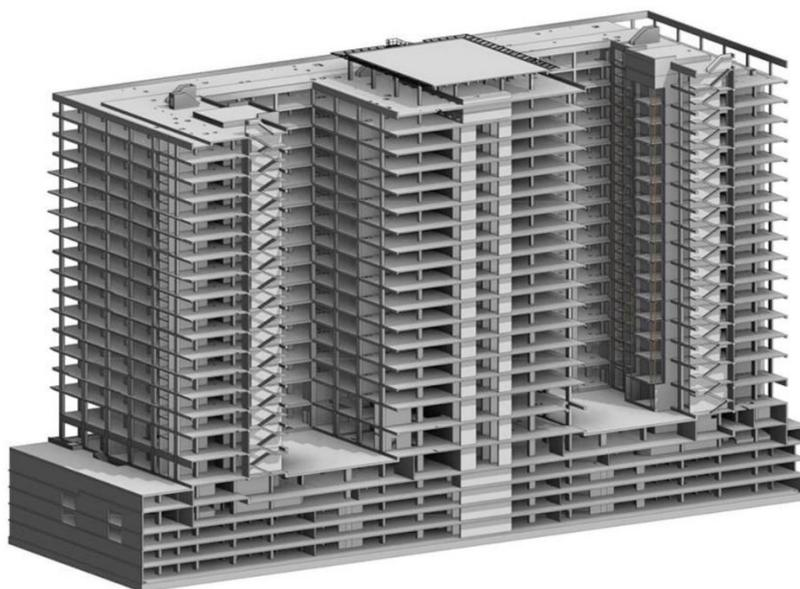
Рис. 2. 3D-модель конструктивной системы здания в Revit Structure.
