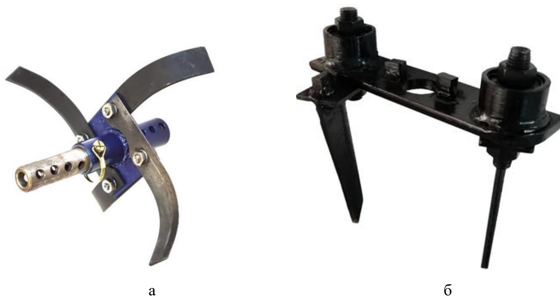
Рис. 6. Адаптивная фреза-культиватор (а) патент РФ 2644592 и комбинированный культиватор (б) патент РФ 188611.
