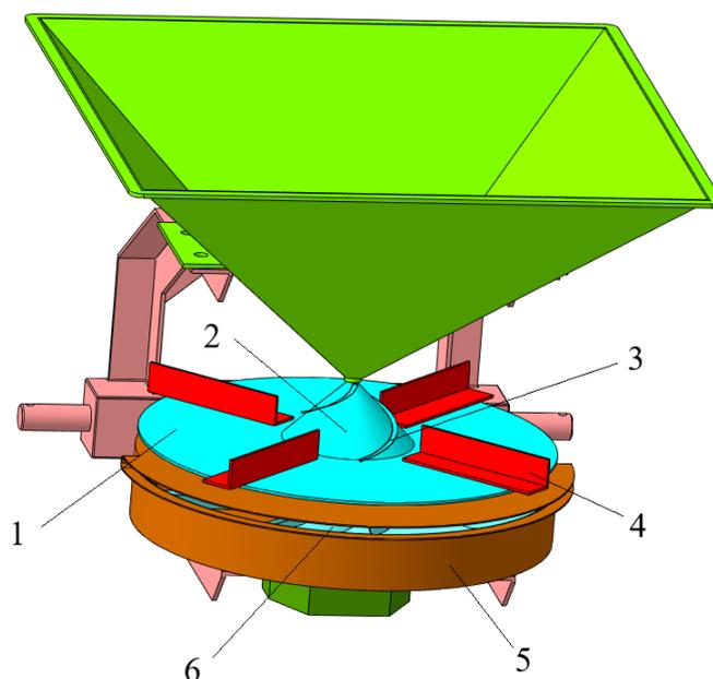
Рис. 2. Адаптивный пневмоцентробежный рабочий модуль:
