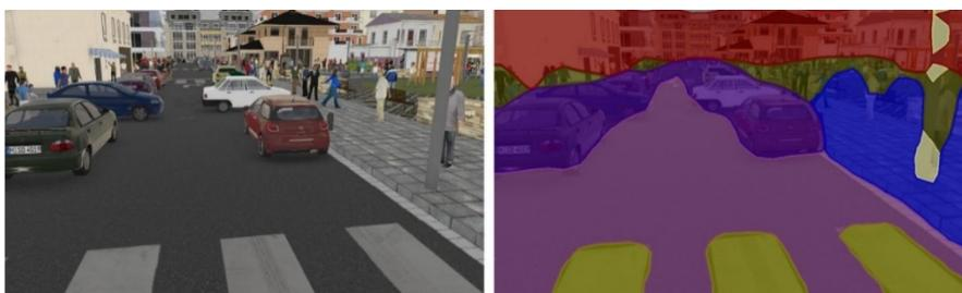
Рис. 4. Семантическая сегментация наблюдаемой обстановки в поле зрения БПЛА
