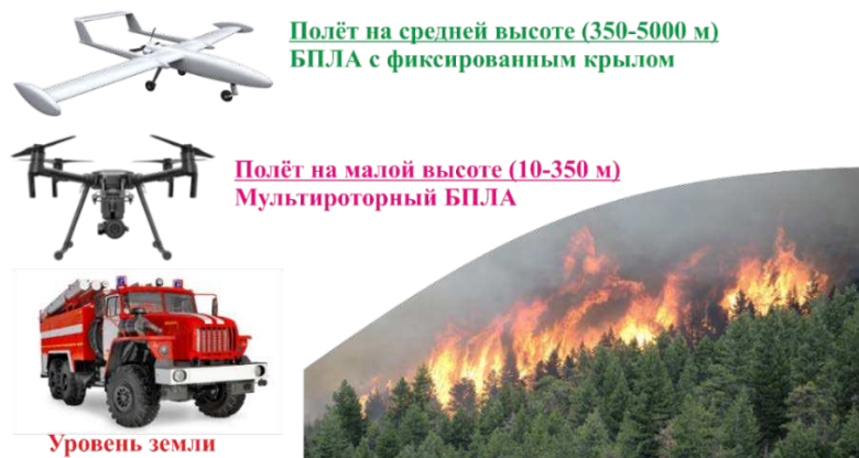
Рисунок 1. Состав системы раннего обнаружения лесных пожаров
