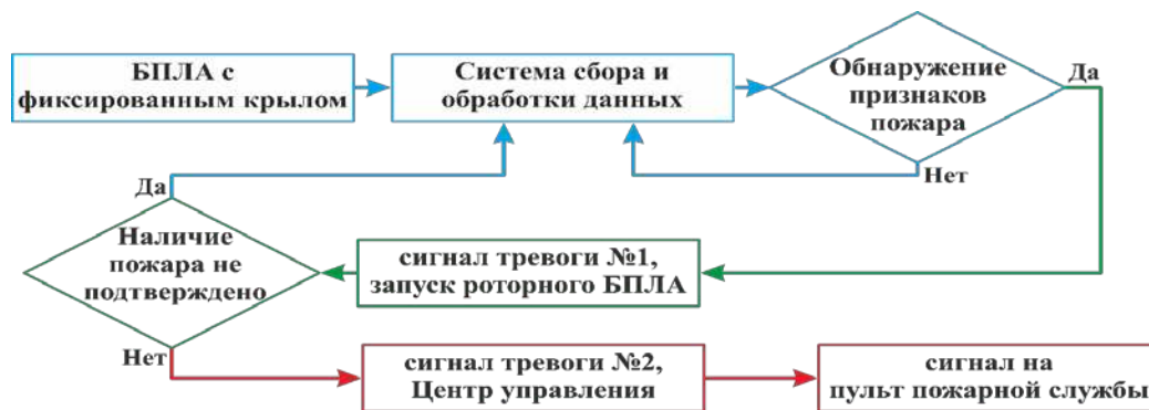
Рисунок 2. Блок-схема операционного принципа ранней платформы обнаружения лесных пожаров
