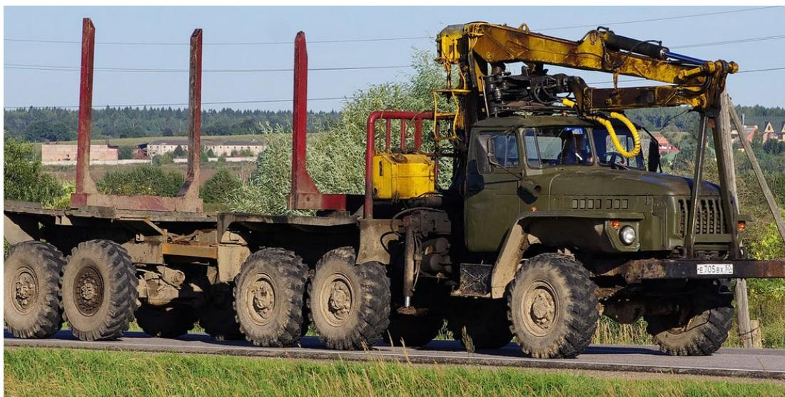
**Фото 10.** Самопогружающийся автолесовоз (с гидроманипулятором) [42]
