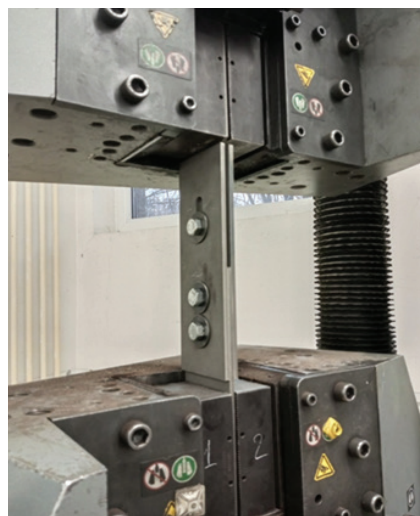
Рис. 4. Испытание образцов на растяжение в разрывной машине
