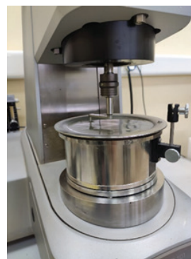
Рис. 1. Определение вязкости и напряжения сдвига бетонной смеси на полых микросферах с помощью ротационного вискозиметра MCR 101
