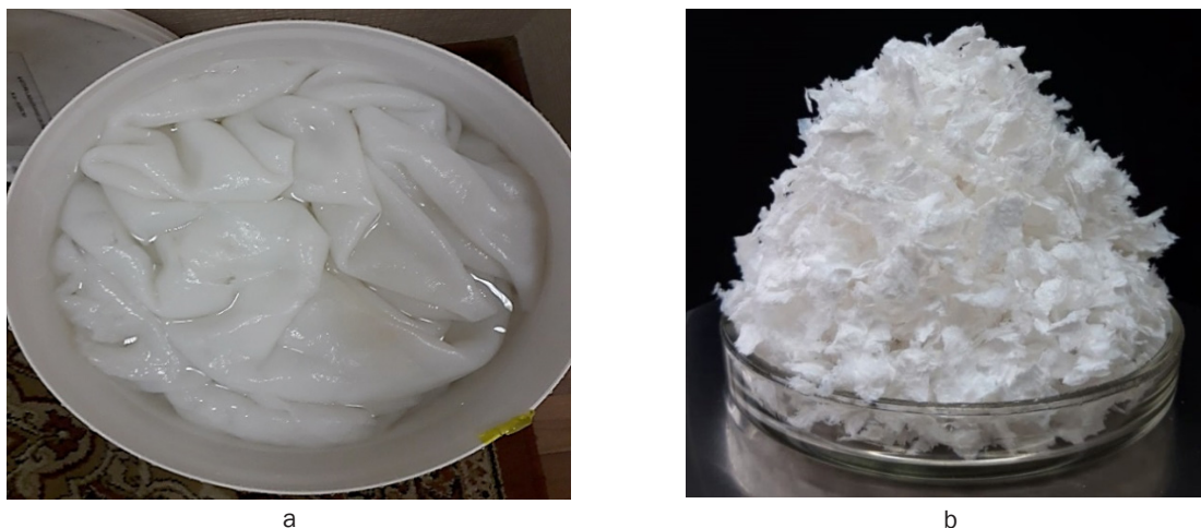
Рис. 1. Исходная влажная бактериальная целлюлоза (а); образец бактериальной целлюлозы, высушенной методом сублимационной сушки в лиофилизаторе (b)
