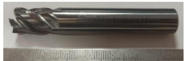
Рис. 2. Схематическое (а) и реальное (б) изображение фрезы с указанием основных геометрических размеров
