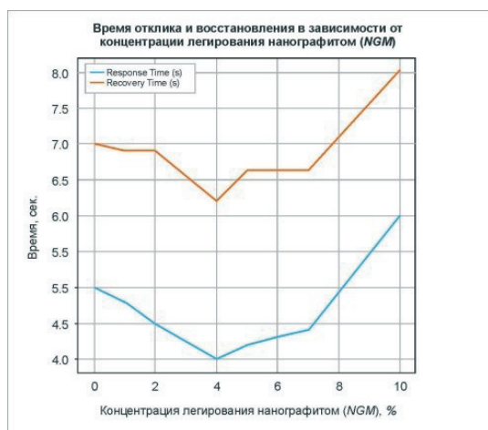
Рис. 8. Зависимость времени отклика и времени восстановления от концентрации NGM (а); зависимость чувствительности по ёмкости от концентрации NGM (б)
