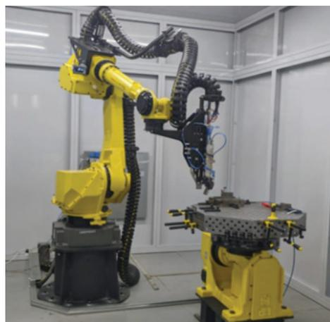
*Рис. 1. Автоматизированный лазерный комплекс*
