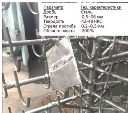
Рис. 4. Образец, установленный для дробеструйной обработки
