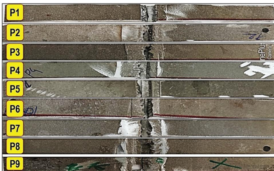
Рис. 8. Характер разрушения UVaFSW-соединений AA7075, подвергнутых дробеструйной обработке
