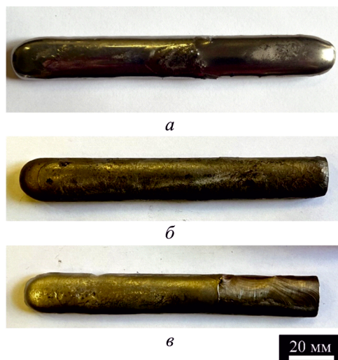
Рис. 1. Фотографии слитков 1 (а), 2 (б) и 3 (в) СПФ TiNiHf после выплавки методом вакуумной электродуговой плавки с 8-кратным переплавом
